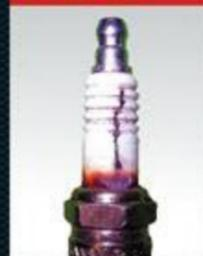
**外观:** 绝缘体上出现垂直于铁壳方向的黑色燃烧痕迹(碳轨迹)。
