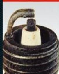
**外观:** 绝缘体变白(未出现褐色),电极上有凹坑或起泡,在有些情况下绝缘体变成灰色或深蓝色。
