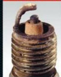
**外观:** 中心电极或接地电极变圆,间隙过大。
