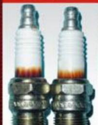
**外观:** 靠近铁壳的陶瓷绝缘体变色。
