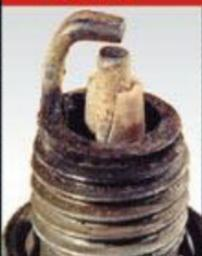
**外观:** 轻微的爆震会在绝缘体或接地电极上产生黑色/灰色的污斑。严重的爆震会导致绝缘体或接地电极出现裂纹甚至破碎。
