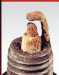
**外观:** 中心电极并/或接地电极表面出现淡褐色的附着物。
