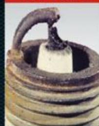
**外观:** 接地电极并/或中心电极熔化(或部分熔化)。
